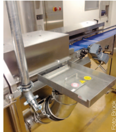
Bild links: Die anfallenden Brotkrümel, die beim schneiden im Slicer entstehen und von den Bandmessern nach oben gefördert werden, fängt das Vibroblech auf. Bild mitte: Nach dem Schneidevorgang im Slicer entfernt die Übersaugereinheit die restlichen Brotkrümel, die sich noch auf der Oberfläche befinden. Bild rechts: Die Handaufgabestelle für Restbrote ist zusätzlich mit einem Staubsaugeranschluss versehen und über eine Rohrverbindung mit dem gesamten System verbunden.
