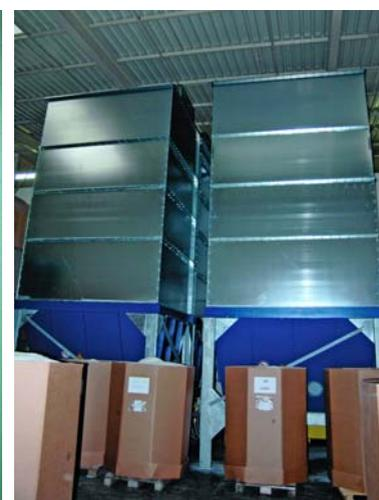
Von den Schneidmühlen wird das Granulat mit Transportventilatoren abgesaugt und dann in vier neu gefertigte 50 m<sup>3</sup> Silos verteilt.
